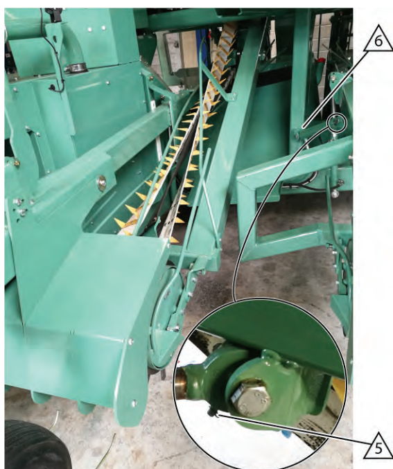
Fig. 99 Lubrifier le vérin du pick-up gauche
