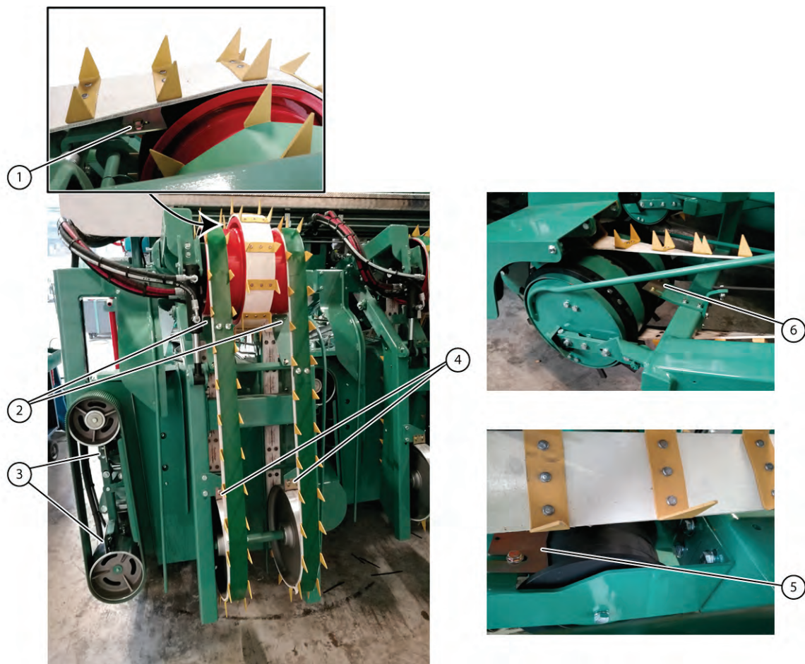
Fig. 78 Emplacement des racleurs
