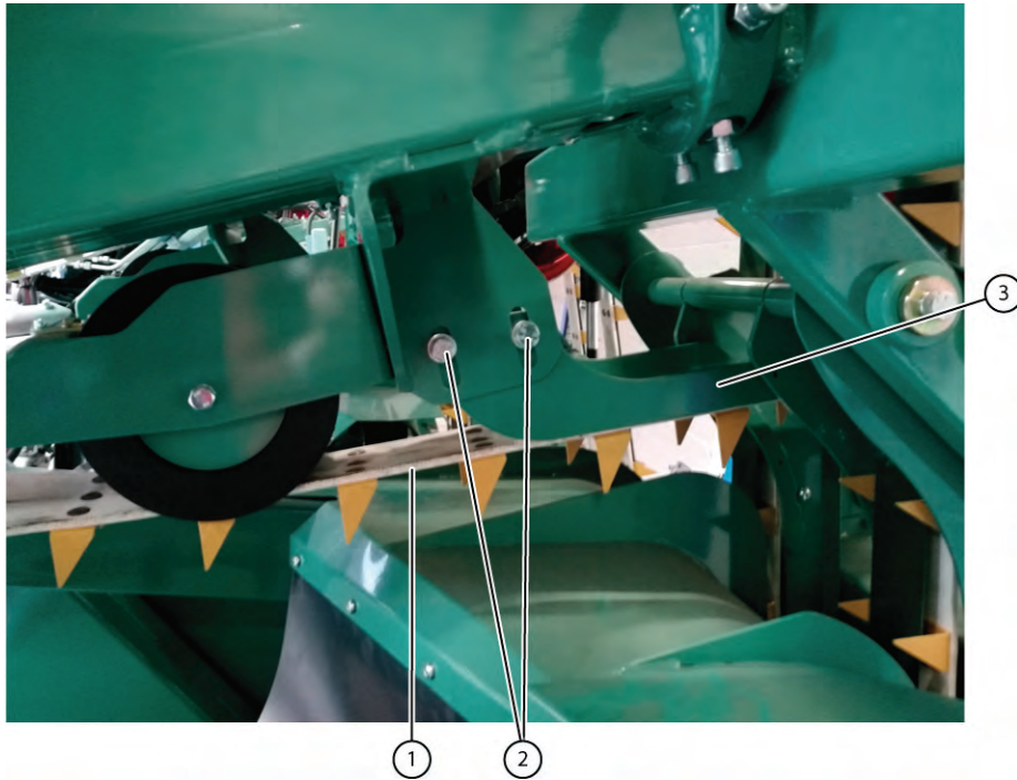
Fig. 84 Régler les guides
