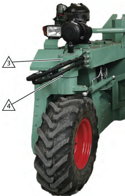
Fig. 98 Lubrifier la roue avant
