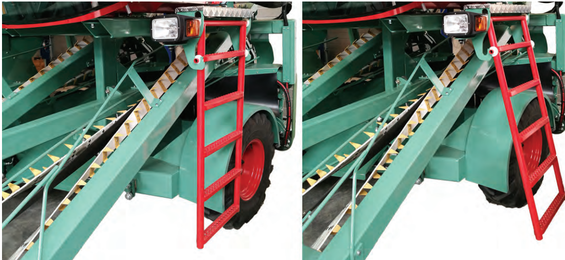
Fig. 10 Échelle repliée et dépliée
