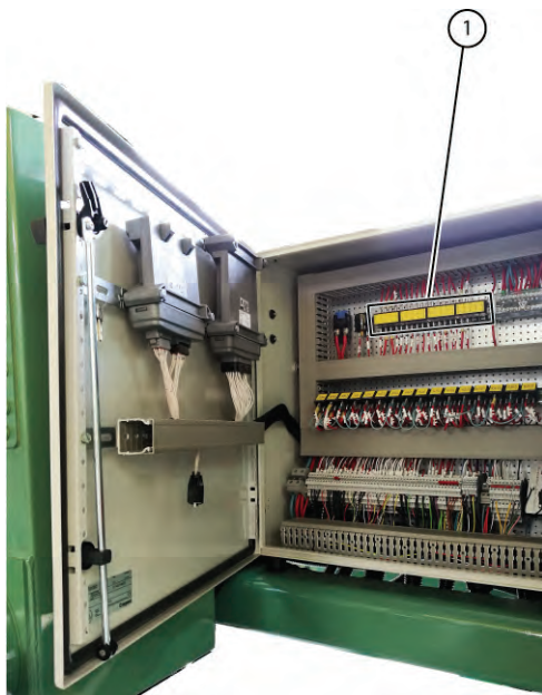
Fig. 115 Remplacer un coupe-circuit dans l'armoire électrique
