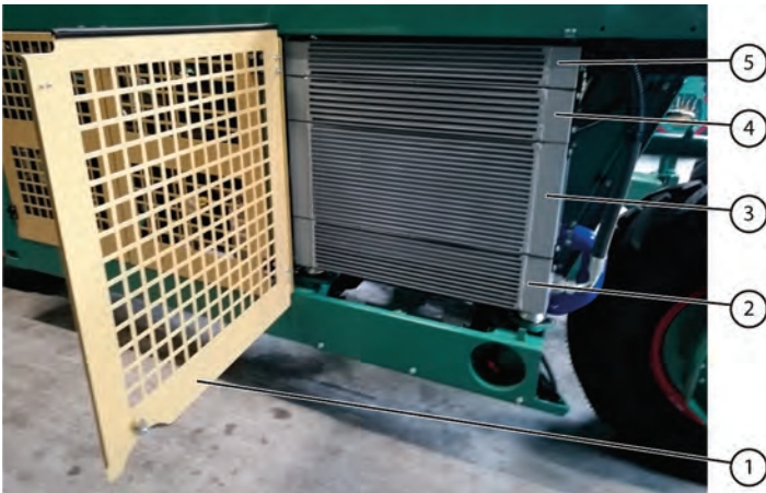
Fig. 89 Nettoyer les radiateurs
